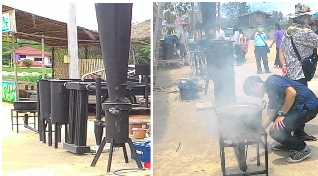
ภาพที่ 21 การทดลองใช้กากเปลือกเมล็ดมะม่วงหิมพานต์เป็นเชื้อเพลิงในเตาแก๊สซีฟเออร์ทั่วไป
