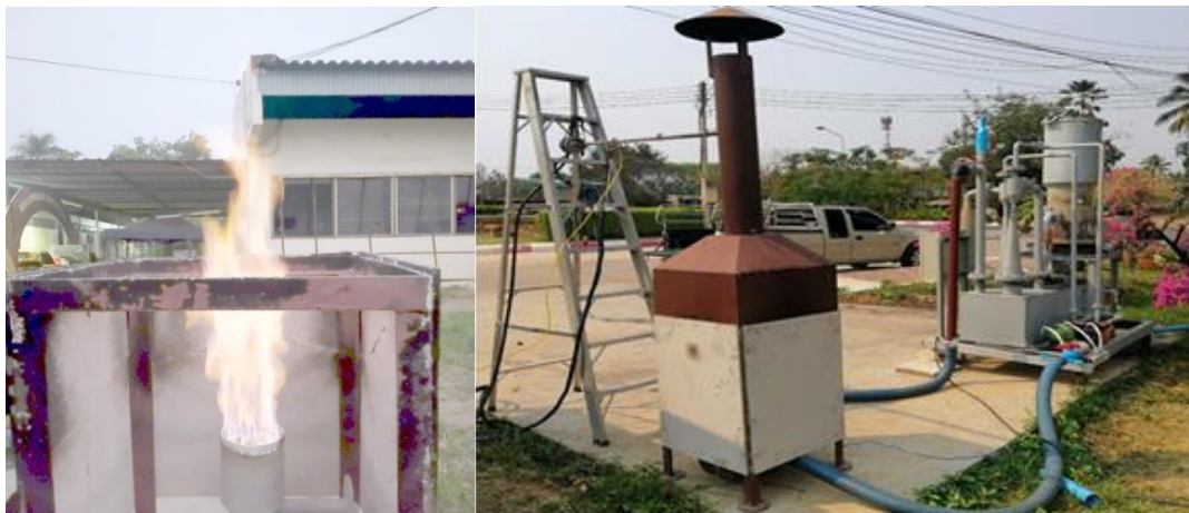
ภาพที่ 30 การตรวจวัดมลภาวะทางอากาศจากการเผาากเปลือกเมล็ดมะม่วงหิมพานต์ด้วยระบบ แก๊สซิฟิเคชันที่พัฒนาขึ้น
