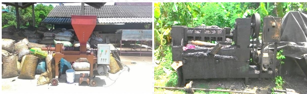
ภาพที่ 18 การสกัดน้ำมัน CNSL จากเปลือกเมล็ดมะม่วงหิมพานต์ด้วยเครื่องสกัดแบบเกลียวอัด
