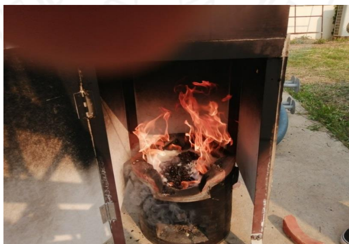
ภาพที่ 12 การเผากากเปลือกเมล็ดมะม่วงหิมพานต์ในเตาดินเผา
